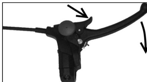
Zum Lösen des Feststellers, den Bremsgriff ziehen und den roten Knopf dabei mit der anderen Hand herausziehen (entarrätieren).
