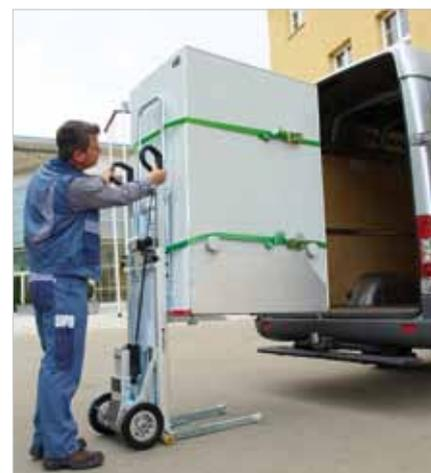
Le gerbeur électrique permet le chargement d'un camion.
