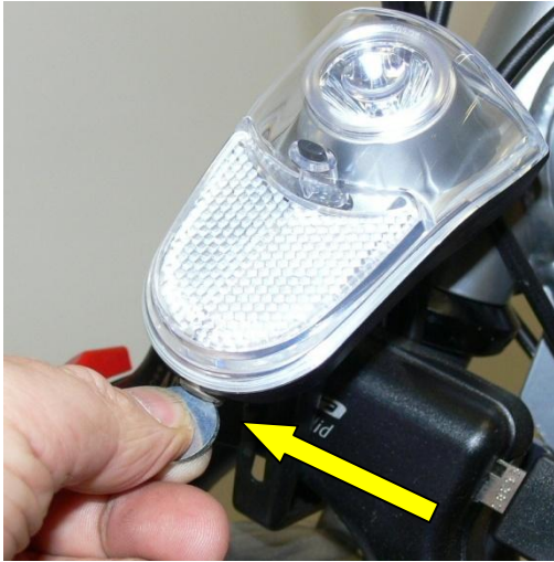
Desserrez la vis de la lampe
