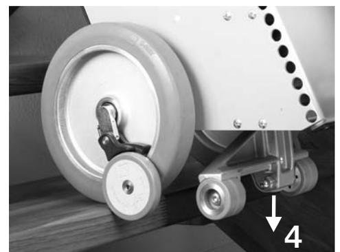
Après que le pied d'appui aie atteint la marche inférieure ⑤ il supporte tout le poids de l'appareil. L'appareil et les roues sont légèrement décollés de la marche supérieure et déplacés vers l'avant et vers le bas.
