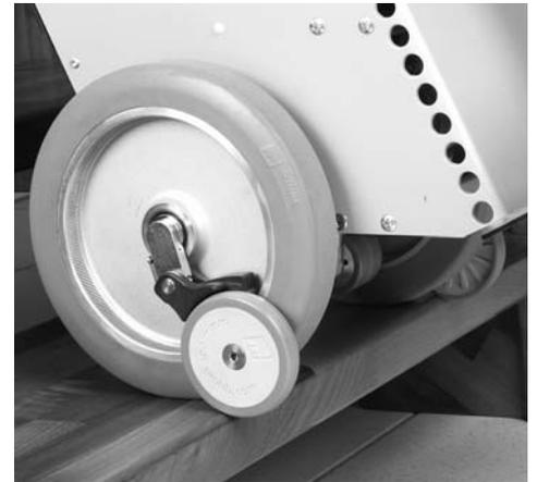
Lors de la montée le s-max sella est tiré légèrement en arrière, et de c fait il roule automatiquement contre la marche suivante. Il se trouve ainsi à nouveau en position de départ : les deux roues se trouvent contre la marche ❷.
