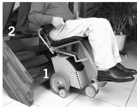
L'appareil se trouve maintenant dans sa position de départ pour commencer la montée.
