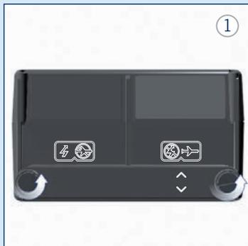
**Passer en mode de circulation - Pack batterie lithium-ion** Desserrer les vis.
