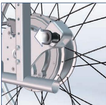
Retirer les boulons d'arrêt de la fixation ⑨.
