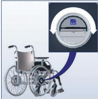
Tourner le dispositif de déverrouillage.
