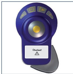
Joystick loslassen und Fahrt unter Berücksichtigung der Ursache (Blockade beseitigen, umdrehen bei zu steilen Steigungen) fortsetzen.
