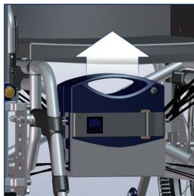
Ouvrir la fermeture velcro et retirer le pack batteries.
